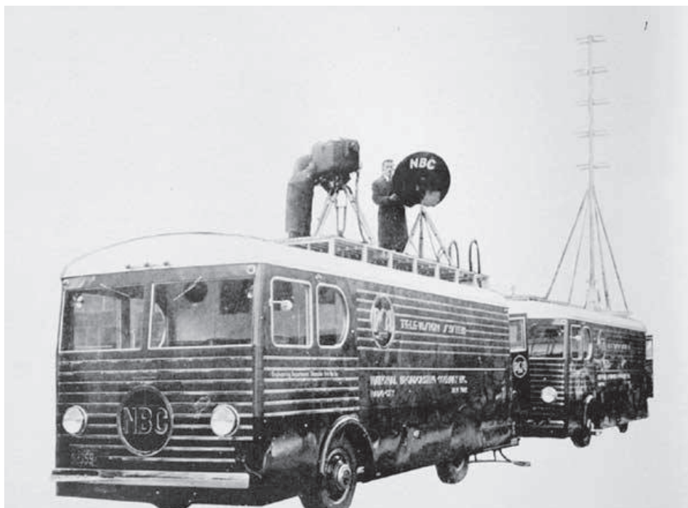
Figura 15: O Automóvel localizado na parte de baixo contém rádio-transmissores usados para conectar o sinal de televisão ao Empire State Building para radiodifusão na antena principal.
